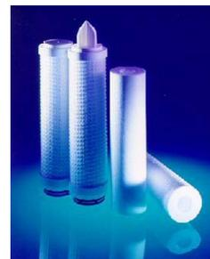
Toplife TPR è, come la serie TPG, un filtro interamente realizzato in polipropilene avvolgendo intorno ad un canotto strati filtranti a diverso grado di trattenimento, in modo da ottenere una matrice filtrante con porosità decrescente dall'esterno verso l'interno. La consistenza degli strati filtranti utilizzati per la costruzione della serie TPR, conferisce una maggiore rigidità alla matrice porosa e permette di realizzare cartucce con gradi di filtrazione anche superiori ai 10 micron.
